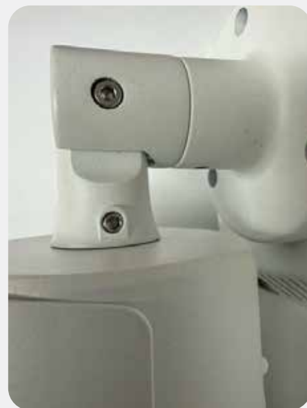
Vis de réglage de la caméra pour le positionnement vertical et horizontal
